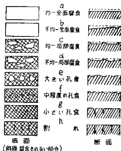
第7図 腐蝕の諸形態
