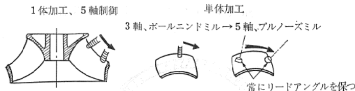
図4 5軸機によって加工される水車ブレードの1例，左図は1体鋳造のランナを，ボールエンドミルを傾けながら曲面切削する。中図は，単体ブレードの場合，直立したボールエンドミルで曲面を加工する，右図は，楕形のカッタを傾けながら，且切削面の法線より常にわずかの前傾を保ちながら曲面切削を行なうもので，切削効率は最も高いがプログラミングは最も難しいものである。
