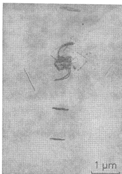
図15 Prismatic punching loop の TEM 像。 (80°C, 240h) + (1100°C, 4 h) の2段 熱処理を施した。
