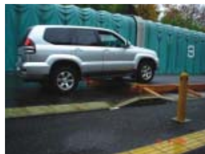
写真-3 段差規模と車両の走行性に関する実験状況
