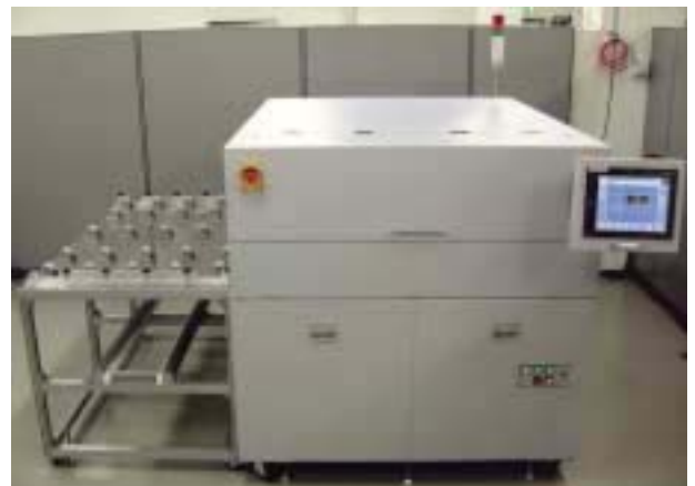
図6 薄膜太陽電池用の自動検査装置
