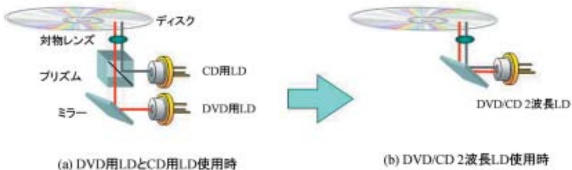
図6 光ピックアップ構成図
