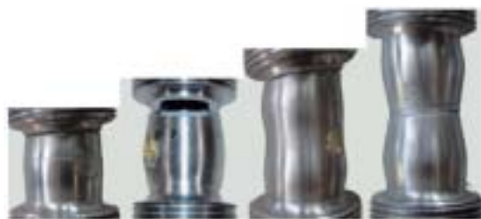
図3 破壊実験後のダンパーの状況
