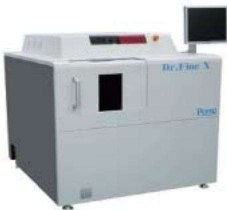
図5 マイクロフォーカスX線装置の外観
