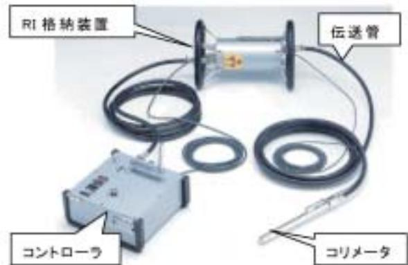
図3 ガンマ線照射装置
