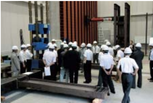
写真4 実大鋼構造柱梁接合部の実験
