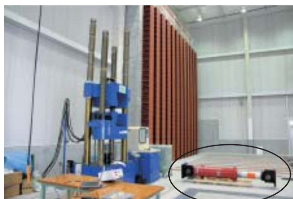
写真3 構造実験室内部(左手前は2000kN アムスラー、楕円内のは3000kN オイルジャッキ)
