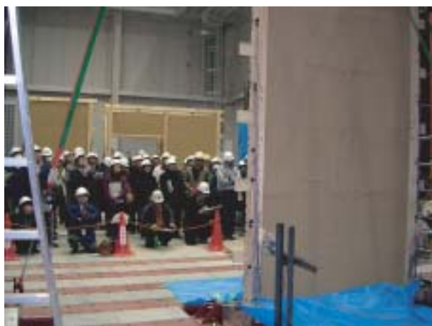
写真6 伝統木造の土壁の耐震性能実験
