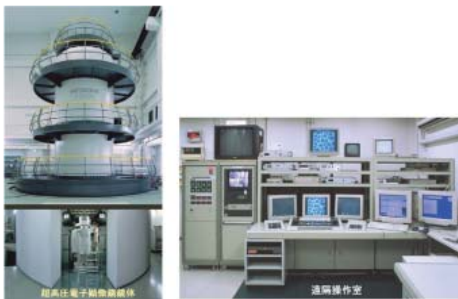
図2-1 超高压電子顕微鏡（左）と、遠隔操作室（右）
