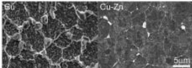
図10 50 /500 時間放置後、室温で500 時間放置した試料の界面組織 (左: 銅、右: 黄銅端子材)
