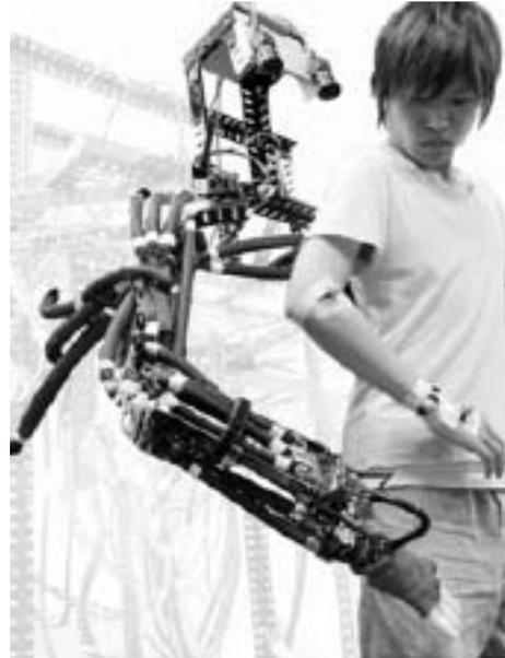
図3：ヒトの上肢の筋肉構造を模倣したヒューマノイドロボット
