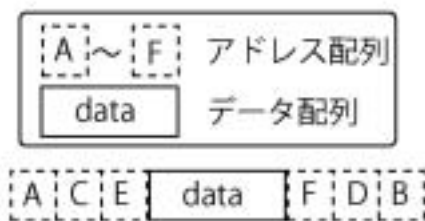
図4: DNA メモリ。DNA がデータ部とアドレス部で構成される。A-F は多層化アドレスの桁を表す。
