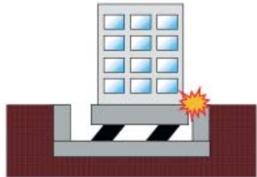
図8 免震建物の擁壁との衝突
