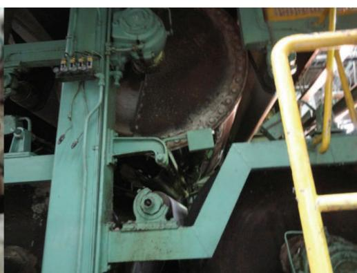
6. フェルトのベルトにパルプを積層させる
