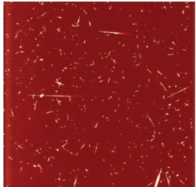
図3: 上: 軽量化と高効率化のために、X 線 CCD をペルチェ素子だけで冷却と機械強度とを持たせたもの。 下: 宇宙空間における X 線 CCD の生画像。細長く伸びた軌跡は荷電粒子によるもので、点に見えるものは X 線による。左端に多数並んでいる横縞は固定パターンである。
