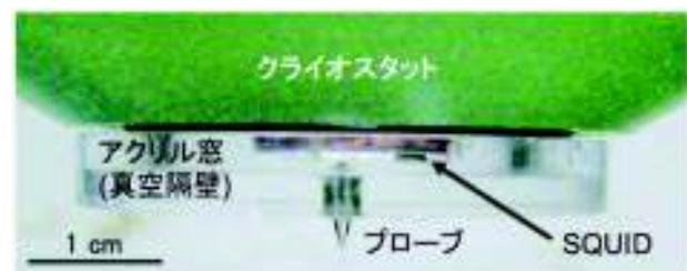
図2 プローブ部の光学写真。
