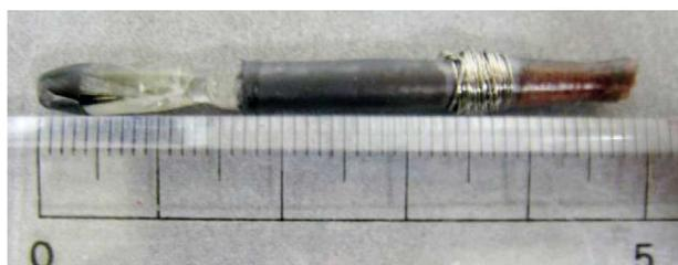
「焼き芋」(2mm/h、右側)から透明な「宝石」(0.5mm/h、左側)への劇的な変化。焼き芋の表皮は未反応の原料などによる茶色、内部は濁った薄淡黄色。
