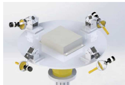
図4 CMGのピラミッド配置
