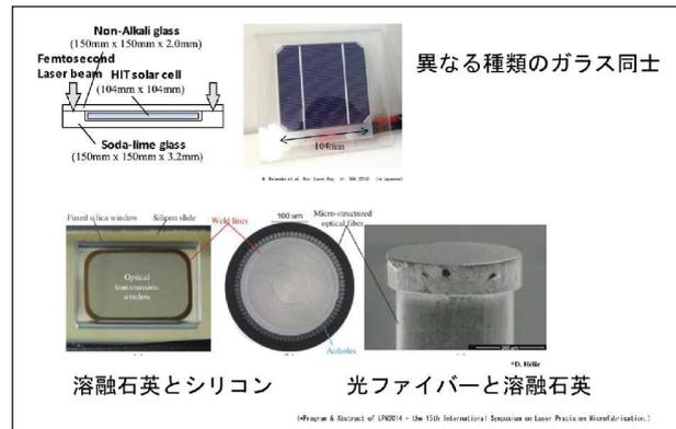
証されています。熔融石英とシリコンの基盤や光ファイバーの先端と接合することで、光学的な機能を持たせたデバイスも提案されています。
