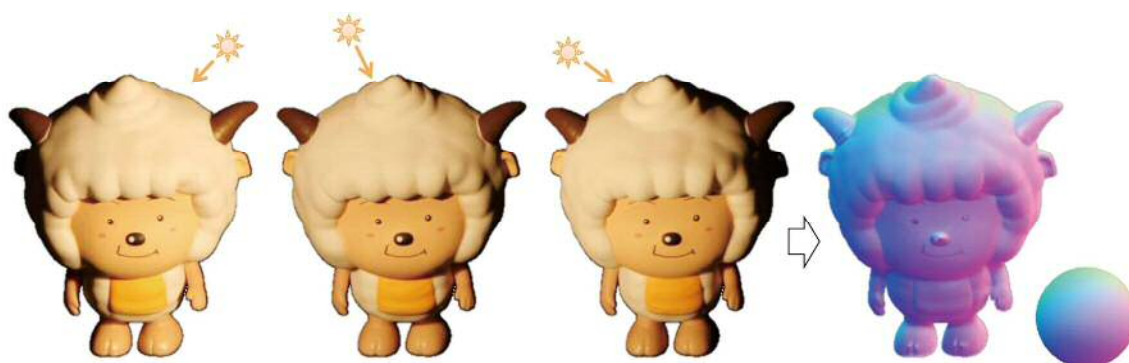
図2: 照度差ステレオ. ランバート拡散反射面の仮定の下では, 最低三つの異なる光源下で撮影された画像から法線ベクトルを推定できる. 左の三つの画像はこれらの入力画像, 右は推定された法線ベクトルをRGBで可視化したものである. 右下の球は, 法線ベクトルとRGBカラーコーディングの対応を示す: (R, G, B)^T = (\mathbf{n} + \mathbf{1})/2 .
