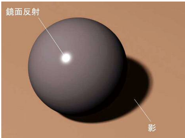
図3: 実際に観測されるシーンには鏡面反射や影などの非ランバート拡散反射成分が含まれる。
