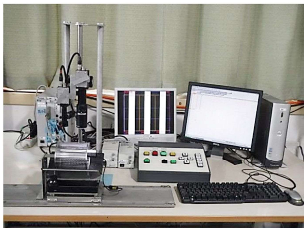
図4 スリット計測装置（高精度カメラによる自動計測）
