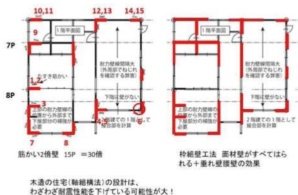
図9 在来軸組構法と枠組壁工法の違い
