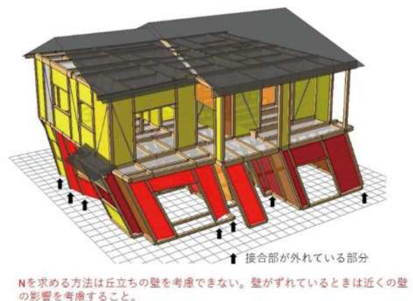
図3 保有耐力接合されていない接合部
