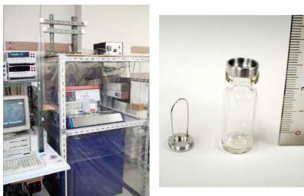
図 1. 生物熱測定システムおよび試料容器 (3.5 mL)
