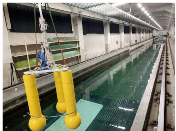
図3 浮体式風車の模型実験 (準備) の様子
