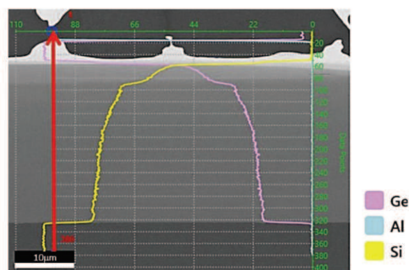
図 5. 1000℃-0s で形成された SiGe 層の断面 SEM/EDX による Ge、Si、Al 元素プロファイル
