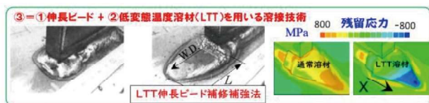
図2 溶接伸長ビードと低変態温度溶接材料の併用
