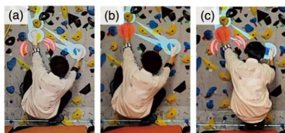
図5 登攀動作における力の込め方のリアルタイム指示 (a) 振動による指示 (b) 投影による指示 (c) 両者の併用
