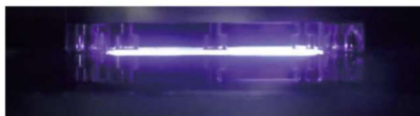
図1 大気圧 VHF プラズマの様子 (電極幅: 80 mm, 電極間ギャップ: 0.5 mm)
