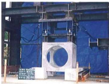
1.2m角ポカラ载荷実験 4隅に計200tf(試験装置最大荷重)を载荷するも破壊せず (139tf/m 2 相当)
