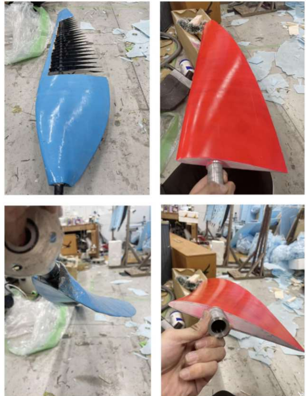
(従来のプロペラ (青) と2024年度プロペラ (赤) のねじれの比較)
