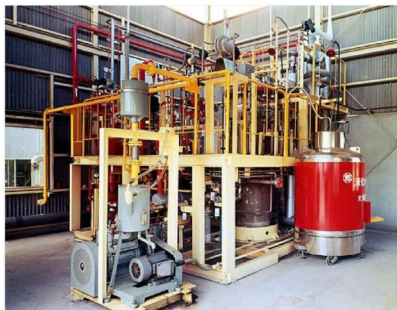
図3 当社初の水素液化設備
